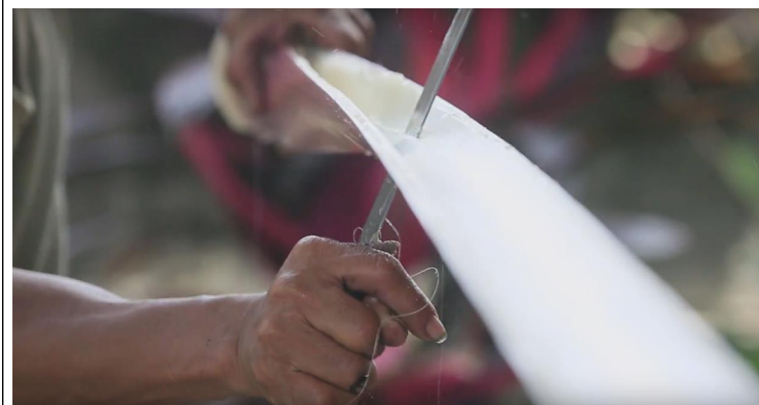
圖 12 將香蕉莖中間較厚部份再分割成數片，寬度約 5 公分
