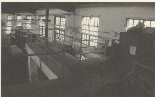
圖 3-26 第一股道三層維修平台檢修 E100 機車
