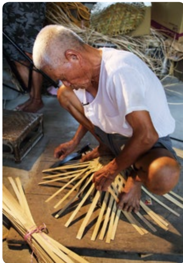
▲製作竹盾需蹲踞在模子上，一邊順時針轉動身體一邊編織修整盾面，講究手腳靈活動作敏捷
