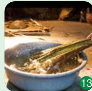
12 - 13 噴水器或盛水器皿：用來潤濕、軟化竹篾，避免因為竹篾因為過於乾燥而斷裂。
