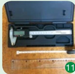
11 尺、軟尺、游標卡尺：尺與軟尺可測量尺寸，游標卡尺測量竹篾厚度。
