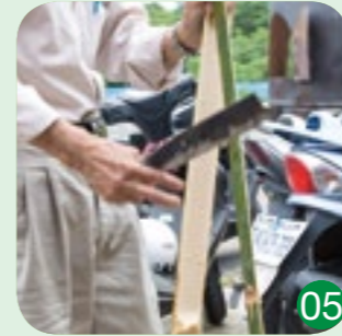
04 - 05 剖篾刀：有單刃（左、右手）及雙刃（左右手通用型）之分，形制相仿，前大後小，用以劈、剖、修整竹材。
