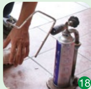
18 - 19 瓦斯噴燈、烤彎棒：為製作日式手提箱箱體之工具，烤彎棒以瓦斯噴燈加熱之後，可以做為烤彎工具，將平面竹編折成直角或其他角度。
