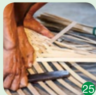
25 - 26 木槌：搭配圓口刀，一邊修邊，一邊敲打讓「目」或榫接處更緊密牢固。
