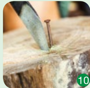
10 砧台：可搭配劍門修整竹篾，傳統上搭配雙劍門使用。
