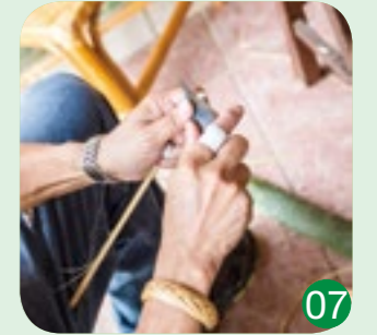
06 - 07 劍門（傳統定寬刀）：劍門為一對，可定竹篾寬度、修整邊緣。臺灣唯有盧靖枝使用單劍門與鐵釘修篾。
