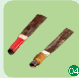
04 - 05 剖篾刀：有單刃（左、右手）及雙刃（左右手通用型）之分，形制相仿，前大後小，用以劈、剖、修整竹材。
