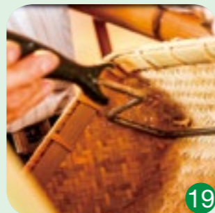
18 - 19 瓦斯噴燈、烤彎棒：為製作日式手提箱箱體之工具，烤彎棒以瓦斯噴燈加熱之後，可以做為烤彎工具，將平面竹編折成直角或其他角度。
