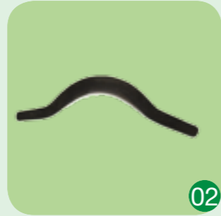
02 - 03 竹青刮刀：弧形鐵器，為刮除竹青的主要工具。
