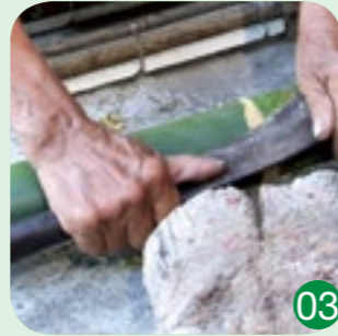
02 - 03 竹青刮刀：弧形鐵器，為刮除竹青的主要工具。
