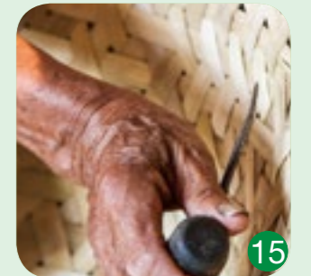
14 - 15 錐子：可用以調整竹篾間隙，或用來幫助籐皮順利穿過孔洞，以便綁紮。
