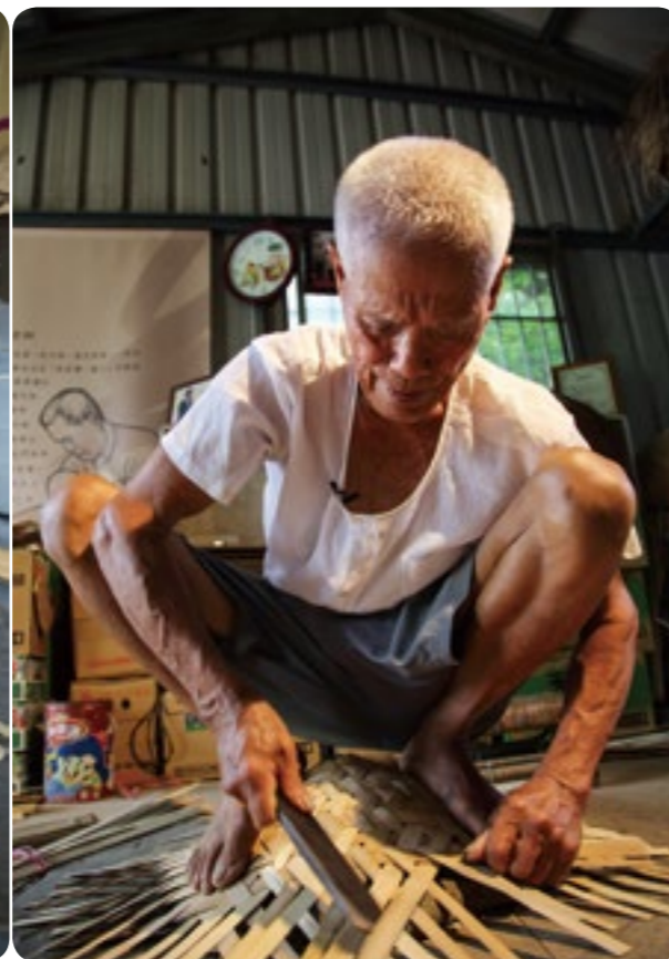
▲製作竹盾需蹲踞在模子上，一邊順時針轉動身體一邊編織修整盾面，講究手腳靈活動作敏捷
