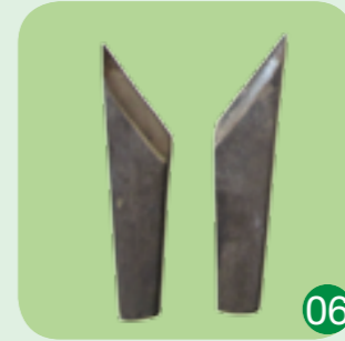
06 - 07 劍門（傳統定寬刀）：劍門為一對，可定竹篾寬度、修整邊緣。臺灣唯有盧靖枝使用單劍門與鐵釘修篾。
