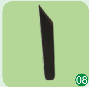
08 整篾刀：刀型一端為斜刀刃（尖狀），可定竹篾寬度、刮製竹絲。
