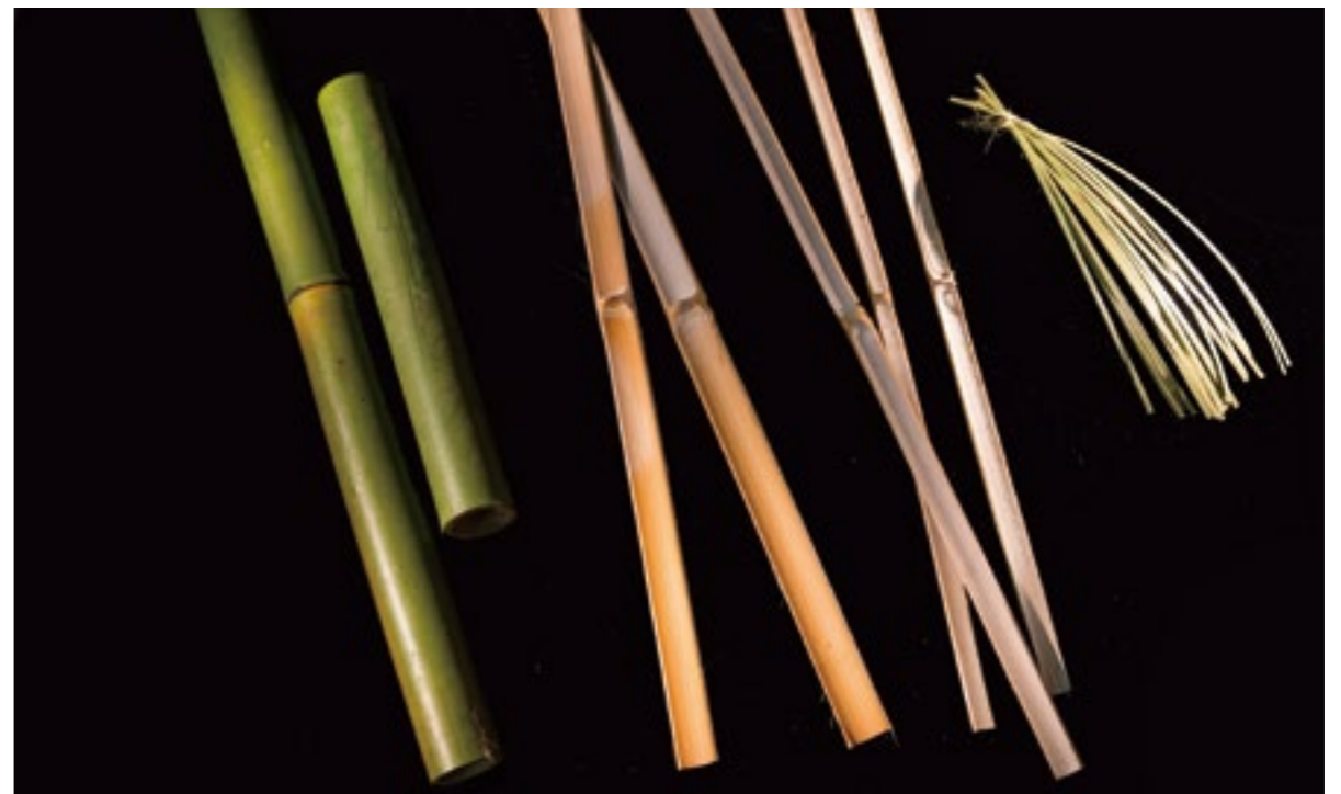
▲ 竹編製作前先用劈刀將竹幹劈成長薄片狀的細竹篾；長枝竹為關廟地區最常使用的竹種
