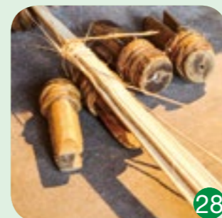
27 - 28 夾子：如長尾夾、螺絲夾具、竹夾等，可以固定形狀。翁明輝製作竹盾時會使用自製的竹夾。
