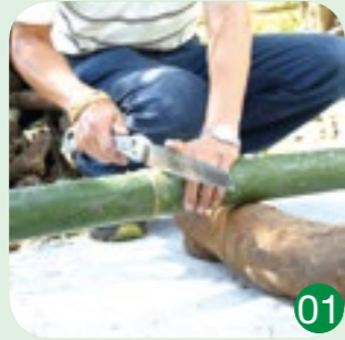
01 鋸子：用以取竹、鋸竹材，有刀鋸、弓鋸多種形制。
