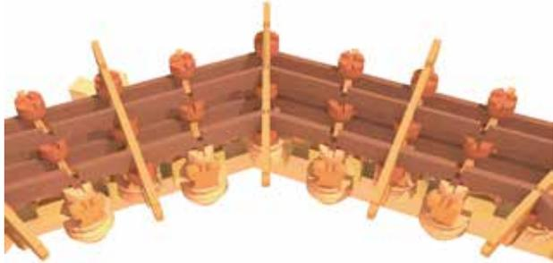
(10) 將三云吊筒拱（中拱）由上往下壓入，以十字搭接樁固定三云前連拱及三云中連拱
