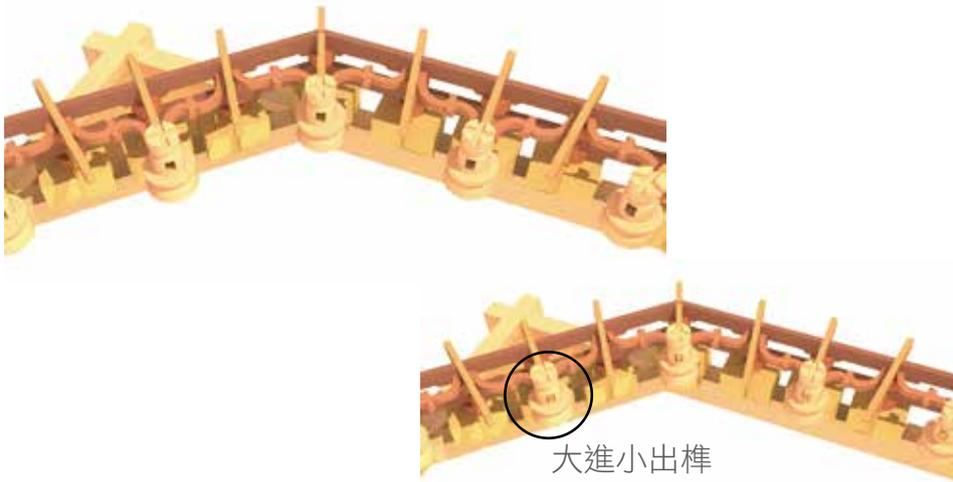
(8) 將一云花籃吊筒放入吊筒拱（角拱、中拱）以大進小出樁固定，並以直樁固定彎枳
