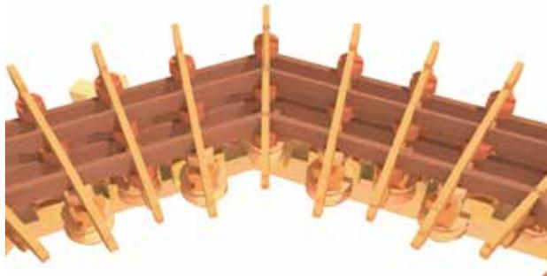
(11) 將三云雌虎拱（左拱、右拱）由上往下壓入，以十字搭接樁固定三云前連拱及三云中連拱
