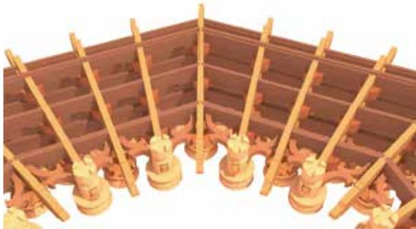
(12) 將四云吊筒放入吊筒拱（左拱、右拱），以大進小出榫固定，並以直樁固定彎枳
