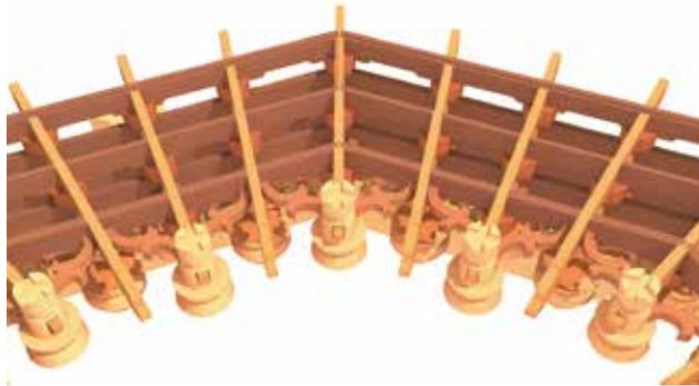
(14) 將三云吊筒放入吊筒拱（角拱、中拱），以大進小出樁固定，並以直樁固定彎枳
