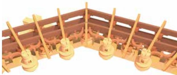
(10) 將二云吊筒放入吊筒拱（左拱、右拱），以大進小出樁固定，並以直樁固定彎枳
