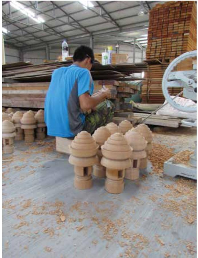
製作吊筒構件、打鑿榫孔
