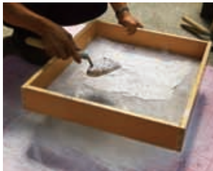
圖1-2-15 網篩過濾石灰粉小粒子
