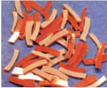
圖1-3-12 鑽筆初步切割下來的玻璃片
