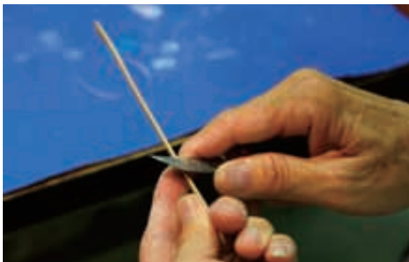
圖2-4-95 美工刀細修竹枝表面
