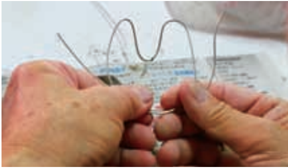
圖2-3-6 將左右兩側鐵線的尾端交叉扭緊
