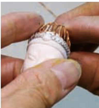
圖1-3-46 戴上白鐵圈、銅圈
