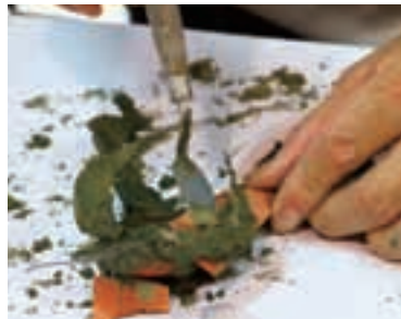
圖2-4-11 麻絨水泥過於濕糊可再加水泥粉
