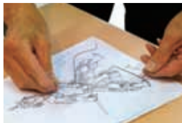
圖2-4-3 凹折雙腿鐵線骨架比對圖面
