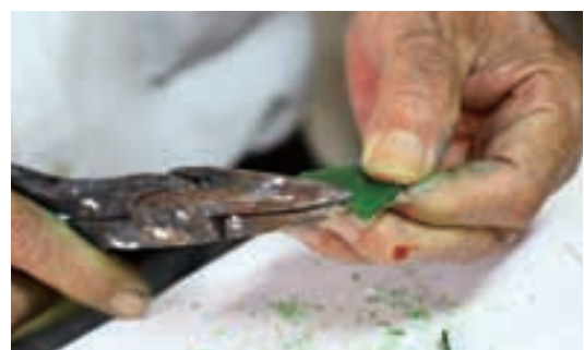
圖1-2-38剪鉗仔鑷嘴在開合之間修剪玻璃片
