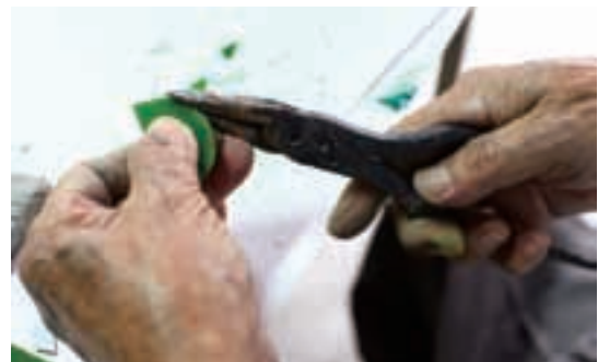
圖1-2-45剪鉗仔將有稜有角的玻璃片細修成橢圓形
