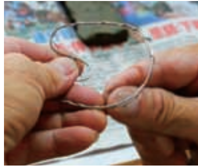
圖 2-3-7 細鐵線纏上粗鐵線骨架
