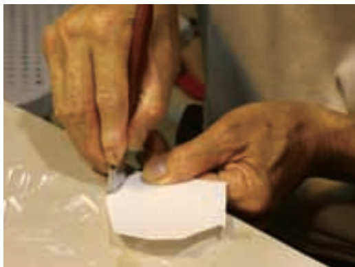
圖1-3-6 用鑽筆初步切割白色玻璃片
