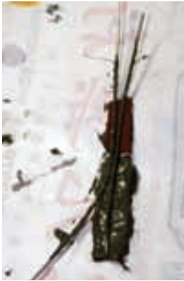
圖1-2-9 第一天把兩條鐵線放在塗麻絨水泥的紅瓦片。
