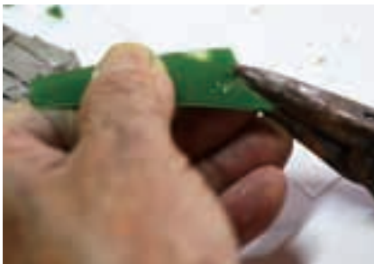
圖1-2-36 以剪鉗仔細修玻璃片形狀
