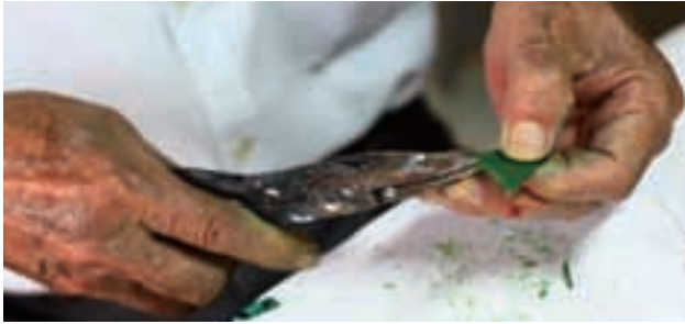
圖1-2-39剪鉗仔不斷來回移動細修玻璃片
