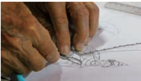
圖2-3-4 藝師把鐵線放至圖面上，用手凹折鐵線。
