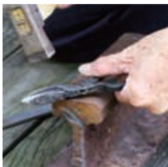
圖1-3-3 在鐵軌上用槓槌仔敲打剪鉗仔
