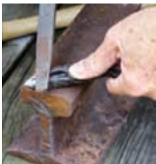
圖1-3-4 鐵刀修磨剪鉗仔
