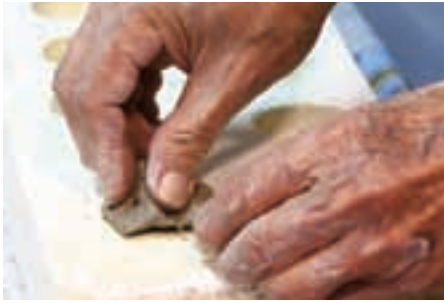
圖1-3-28 用硬黏土夾起模具內的軟黏土
