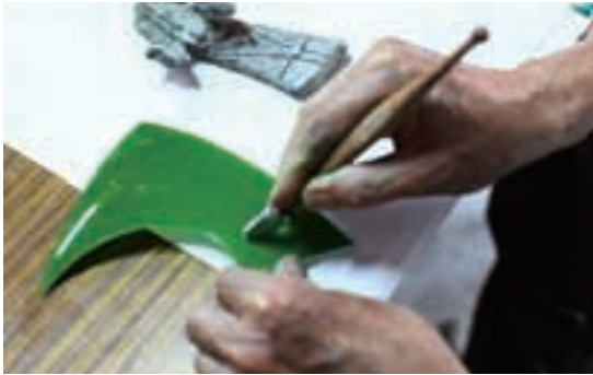
圖1-2-34用鑽筆切割玻璃片
