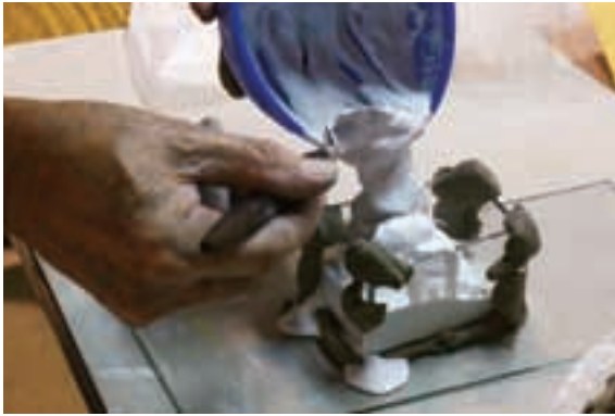
圖1-3-22 將攪拌好的石膏泥倒入透明玻璃圍起的容器中
