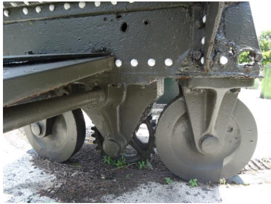
圖 4-13 滑輪上架孔蝕
