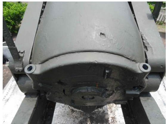
圖 4-04 炮門開關及把手零件遺失炮體上有孔蝕
