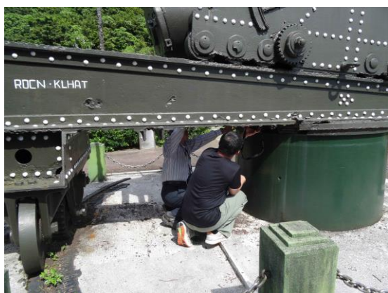
圖 4-23 右轆架上有許多彈片炸傷痕跡，重新上漆後加寫與本炮無關的英文字
