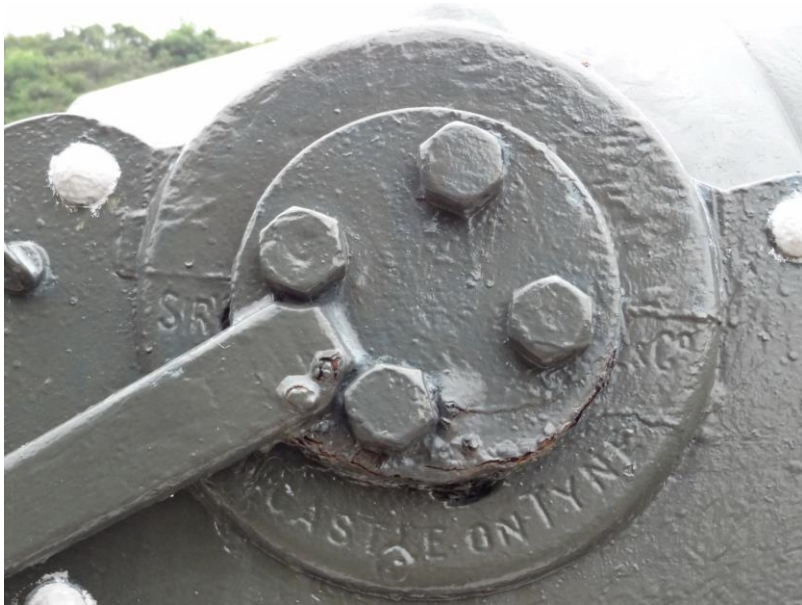
圖 3-05 阿姆斯脫朗後膛 8 吋炮右炮耳上有該公司的名字及所在位置的凹鑄字
