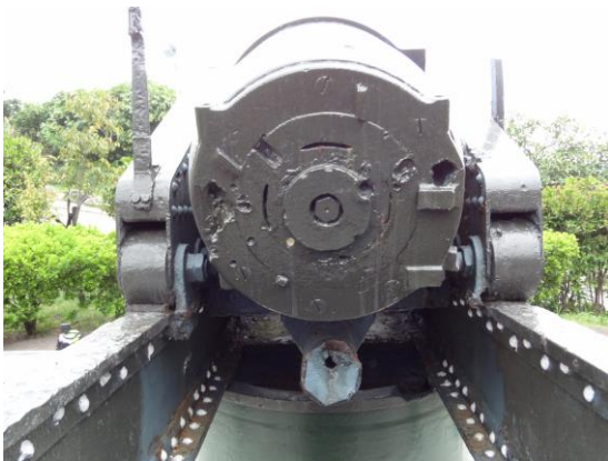
圖 4-03 炮門卡死且左側有因戰爭損壞的缺口
