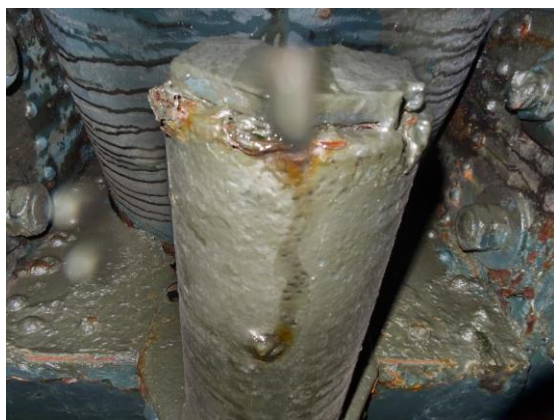
圖 4-19 液壓避震器端部選擇性浸蝕
