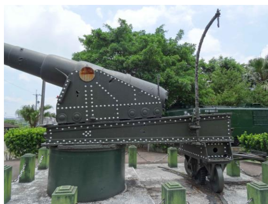
圖 4-24 左轆架及炮身上有許多彈片炸傷痕跡
