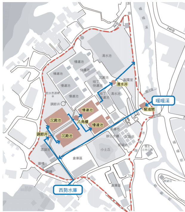
圖 8-2-9 日治時期(1917-1923)淨水場過濾流程示意圖
