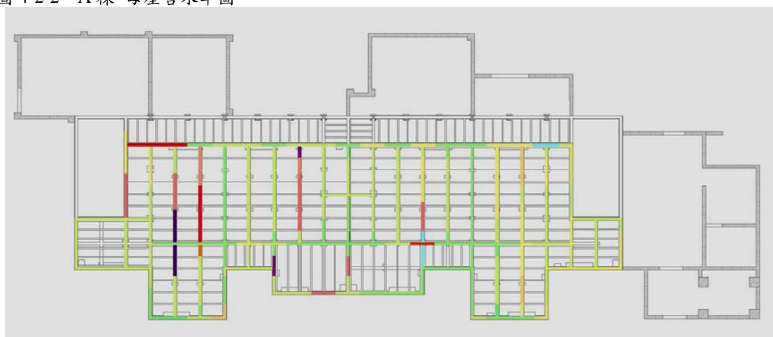
圖 4-2-3 A 棟大引、土台含水率圖
